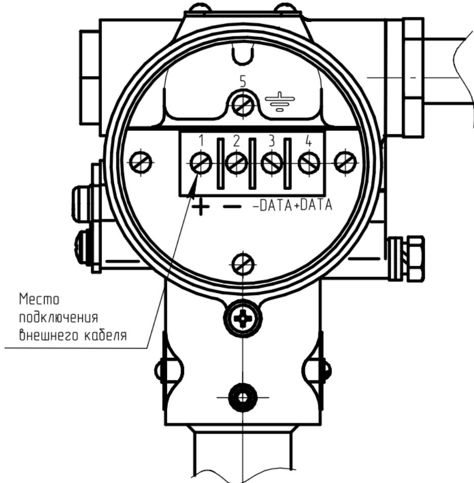
Рисунок В.1 — Клеммная колодка преобразователей всех исполнений, исключая модификацию S по таблице А.6.
