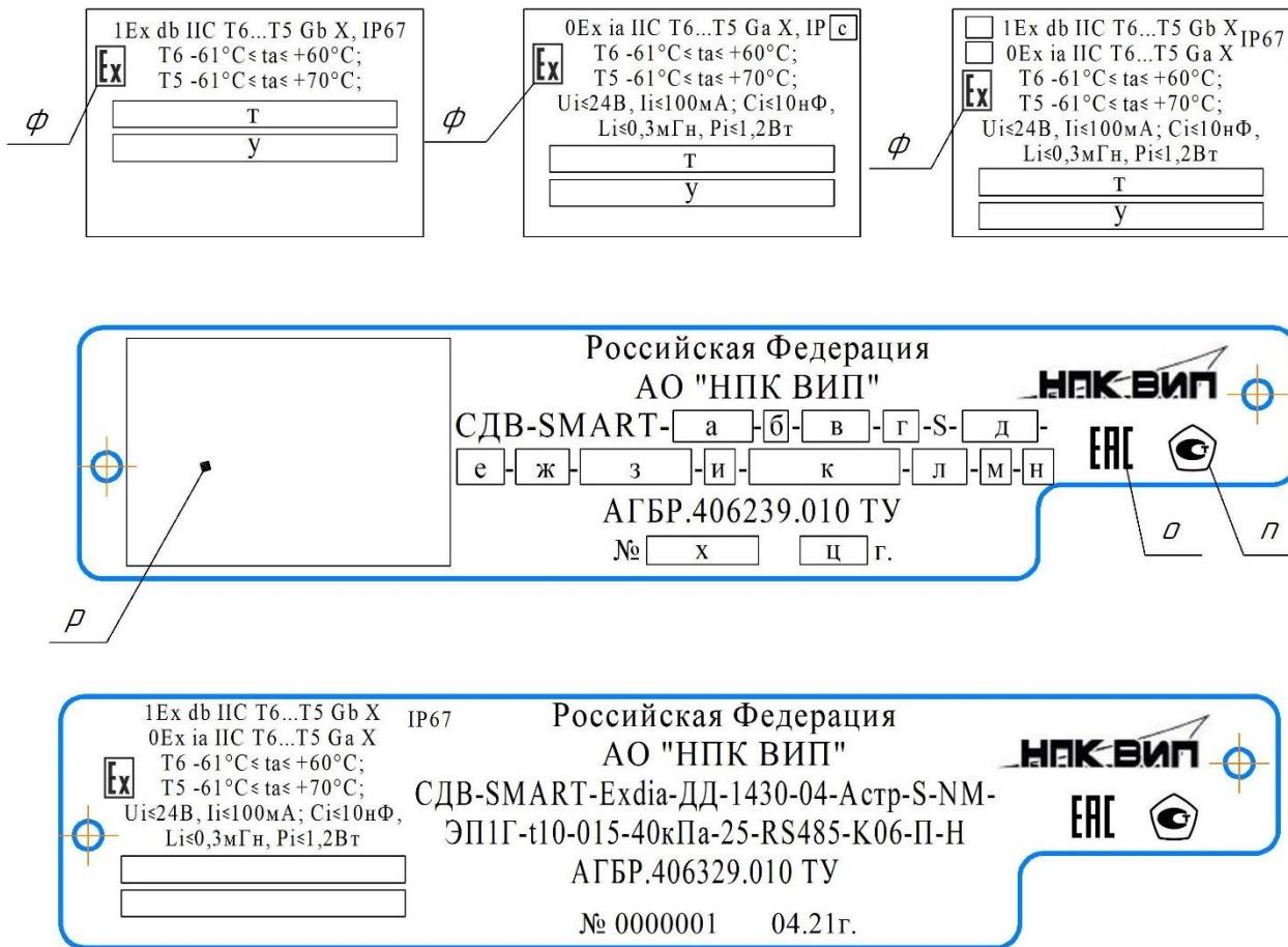
Рисунок Г.15 Маркировка преобразователя конструктивного исполнения S по таблице А.6
