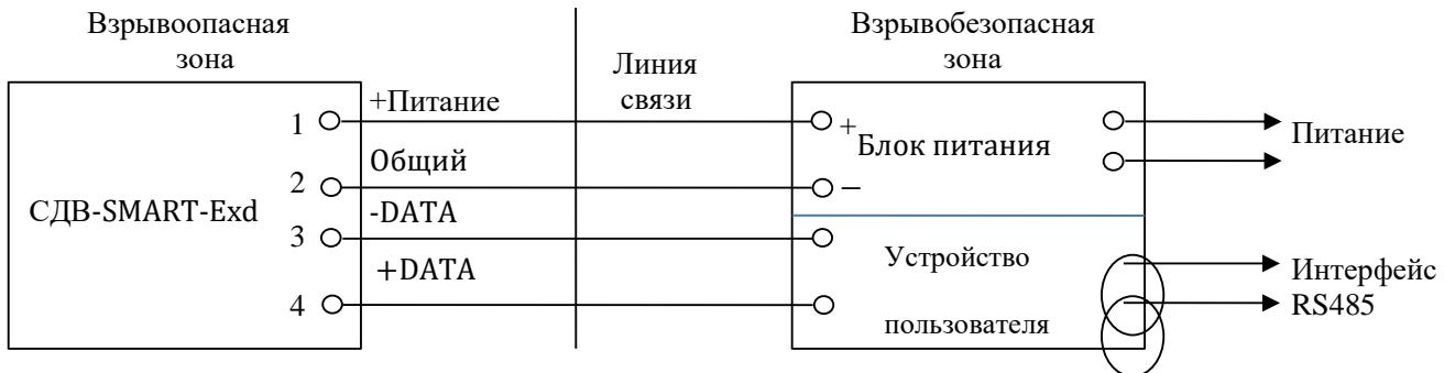
Рисунок Д.1 — Схема внешних электрических соединений преобразователей СДВ-SMART-Exd
