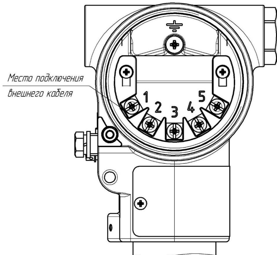
Рисунок В.2 — Клеммная колодка преобразователей с конструктивным исполнением S по таблице А.6
