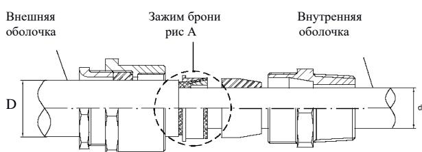
1. ввернуть корпус ввода 1 с прокладкой 2 в корпус оборудования
